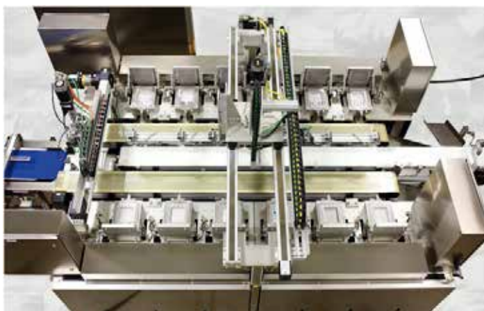
100% 在线静脉输液袋容器密封完整性测试
